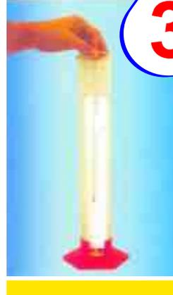
Introduzir o termômetro e agitar continuamente a amostra, tendo o cuidado de manter a coluna do mercúrio totalmente imersa. Uma vez estabilizada a temperatura, mantendo o termômetro imerso no etanol, efetuar a leitura e anotar.
