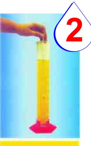
Introduzir o termômetro e agitar continuamente a amostra, tendo o cuidado de manter a coluna do líquido ecológico totalmente imersa. Uma vez estabilizada a temperatura, efetuar a leitura a anotar.
