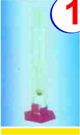
Colocar quantidade suficiente de etanol à examinar em uma proveta, de modo que o densímetro flutue livremente, sem tocar o fundo ou as paredes da proveta.
